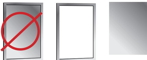
Figure 7: Galvanisez séparément les cadres épais des tôles/plaques minces
