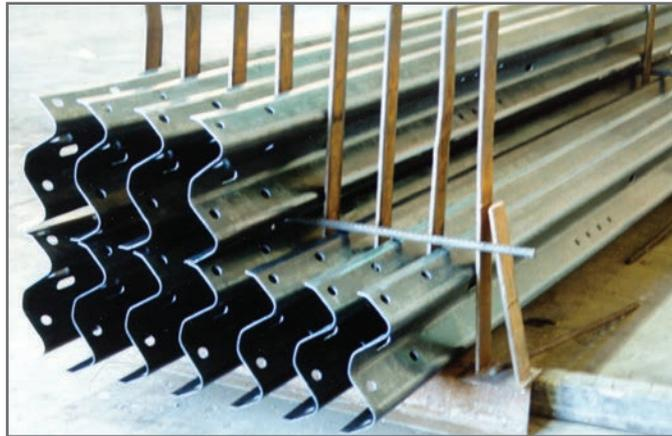
Stockage approprié d'acier galvanisé pour éviter les taches de stockage humide
