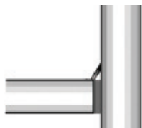
Figure 33: Écart de 2,5 mm (3/32 po) après soudage
