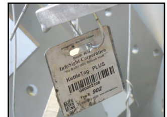
Figure 40: Les étiquettes de codes à barres métalliques conçues pour résister au processus HDG peuvent être facilement retirées
