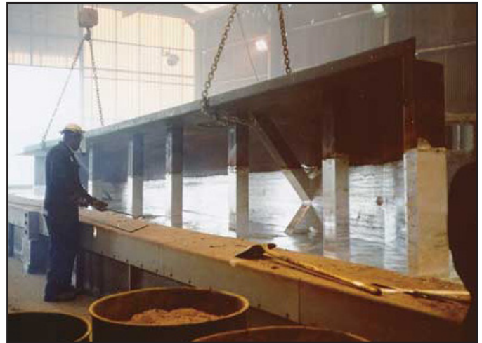
Le trempage progressif augmente la dimension maximale qui peut être galvanisée à chaud.
