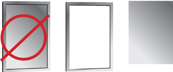
Figure 7: Galvanisez séparément les cadres épais des tôles/plaques minces
